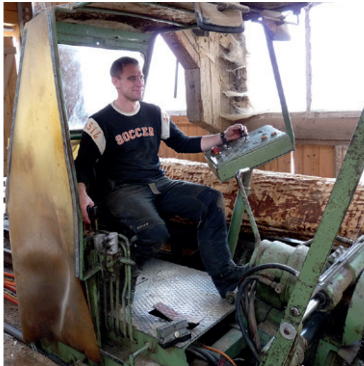
Martin Stäheli führt einen Stamm in das Vollgatter.
