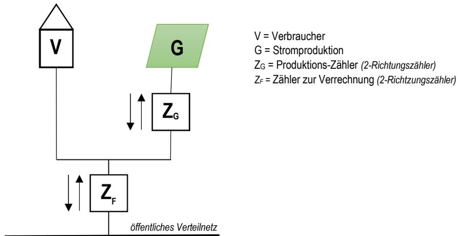
**Beispiel 5** Messung nach Eigenverbrauchsprinzip - mit Stromspeicher → aufladbar aus dem Verteilnetz
