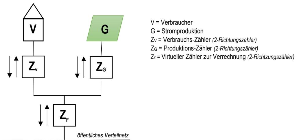
**Beispiel 4** Messung nach Eigenverbrauchsprinzip - Stromerzeugungsanlage über 30 kVA → Reihe
